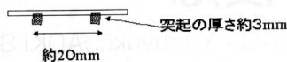
図1 電解支持板 (透明プラスチック製 厚さ約2 mm)。 12ウェルプレートの一つの穴 (直径約20 mm) に固定できる ようにリング状の突起を接着したもの。
