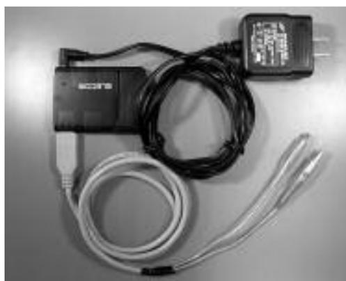
図2 USBハブを利用した電源装置
