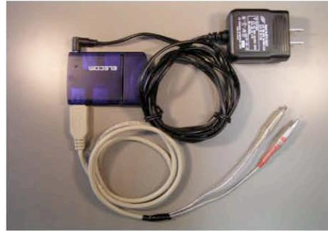
図 2 USB ハブを利用した電源装置
