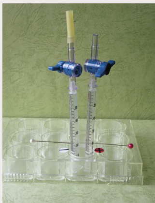
写真 2 1 mL 注射器 2 本、マイクロプレートでつくった電解装置。右のように、片手で持って歩きまわりながら、見せることもできる。
