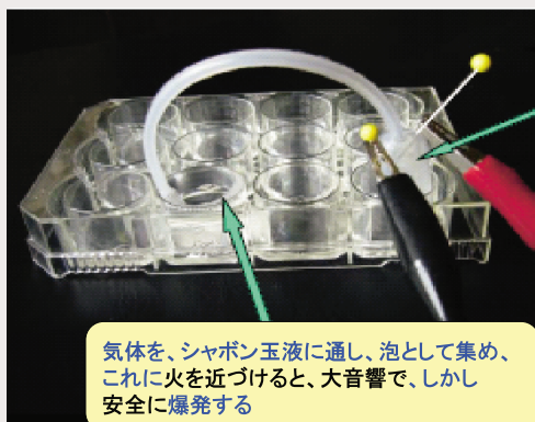
写真 1 マイクロスケール実験装置中の電解
