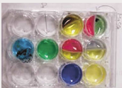
写真3 生徒が行った電気分解の探究実験の結果(電解質と指示薬の組合せで多彩な色が発現する)。吉野輝雄氏撮影
